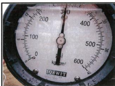
MANOMETRO MUESTRA PRESION DE PRUEBA (21 Kg/cm²) EN SELLO "B"
